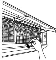
5. **Nasadte vzduchový filter a filter na čistenie vzduchu s fotokatalytickým dezodorizačným filtrom na pôvodné miesto a prednú mriežku uzavrite.**
